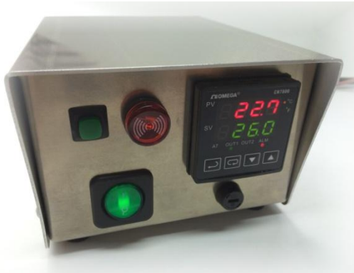
Grad C Empirische Optimierung der P. I. D. Parameter am Beispiel eines A-senco Controllers der Fa. Pohltechnic.com Regelung einer el. Heizung mittels SSR-Relais oder Phasenanschnittsteuerung.
